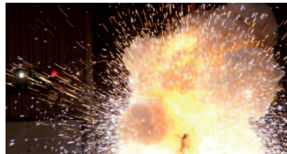
Arc flash 7 kA
